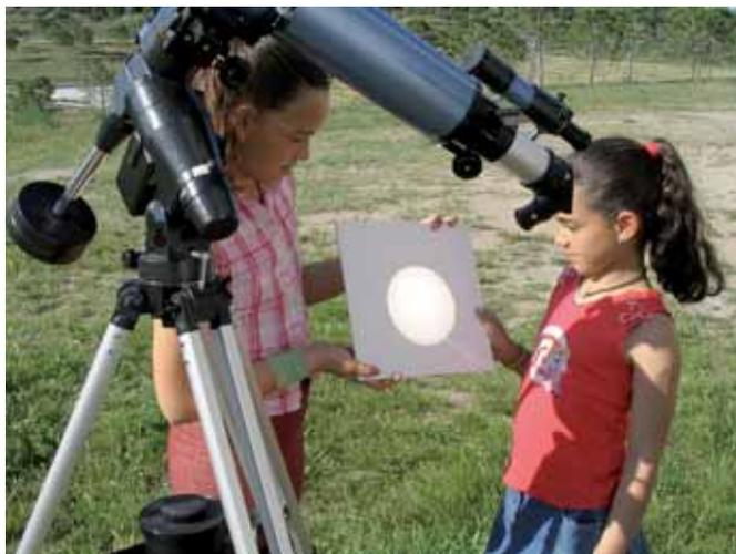
Fig. 3.- Método de proyección solar sobre una pantalla.
