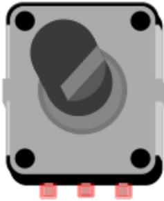
Un potenciómetro es una resistencia variable en la cual podemos elegir el valor que puede tomar. De esta forma, controlamos la intensidad de corriente que fluye por un circuito.
