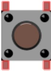
Un botón o pulsador es utilizado para activar alguna función. Los botones son por lo general activados al ser pulsados, normalmente con un dedo. Un botón de un dispositivo electrónico funciona por lo general como un interruptor eléctrico, es decir en su interior tiene dos contactos, si es un dispositivo NA (normalmente abierto) o NC (normalmente cerrado), con lo que al pulsarlo se activará la función inversa de la que en ese momento este realizando.
